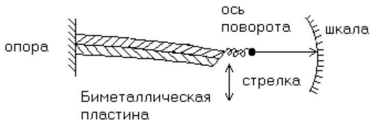
Рис. 2. Схема биметаллического термометра
