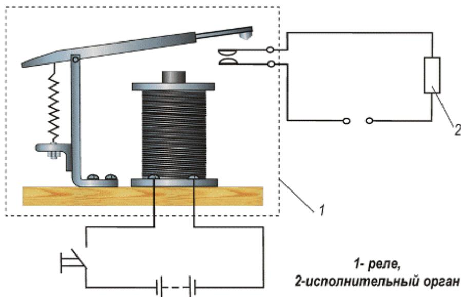
Рис. 14. Схема реле
