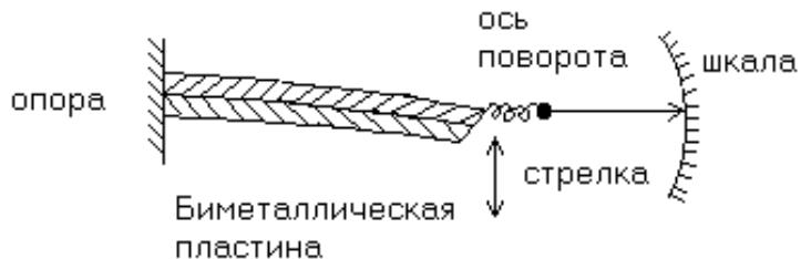
Рис. 2. Схема биметаллического термометра
