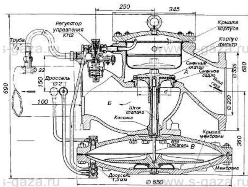
Рис. 20. Схема регулятора давления непрямого действия РДУК - 2
