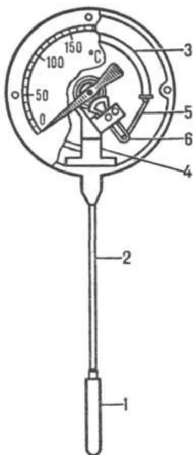
Рис. 5. Схема манометрического термометра
