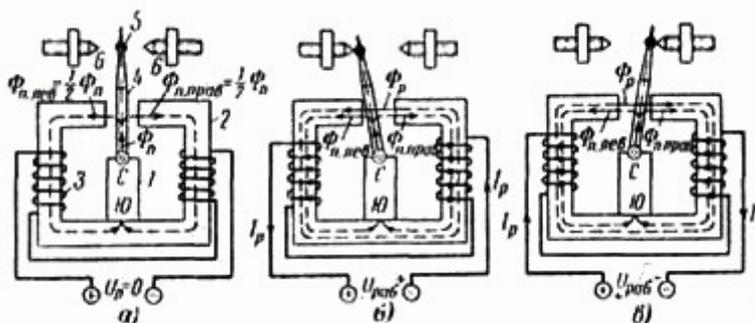
Рис. 15. Принцип устройства и действия поляризованного реле.
