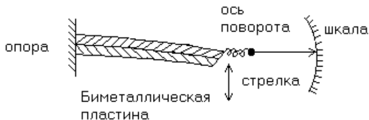
Рис. 2. Схема биметаллического термометра
