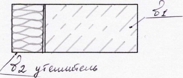
Примечание- Наличие гибких связей в кладке и их теплопроводность не учитываем.
